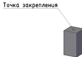
Рисунок 8.3 – Пример выполнения знака закрепления строительных осей
